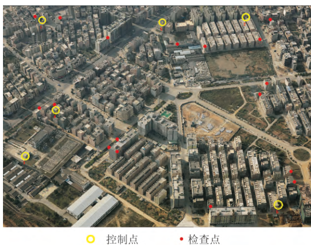
图2 阳江地区控制点和检查点分布示意图
